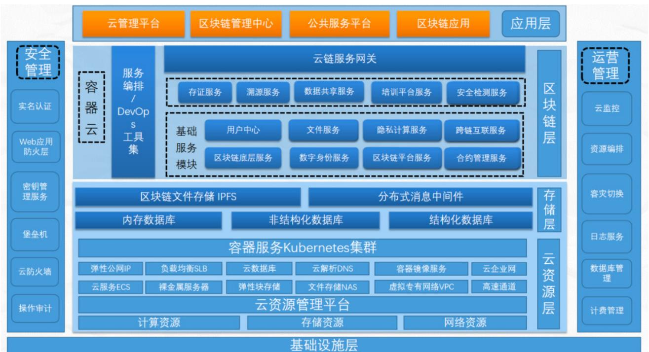
平台通过底层基础设施搭建云资源管理平台,利用分布式控制器、容器化 OpenStack 等技术的深度融合、有机互补,组成云资源层,实现对计算、存储、网络等资源的统一管理和调度,并对外提供标准的 API 接口。以云资源层为基础,部署数据库与文件存储,具备基本的消息中间件,组成存储层。在存储层之上,采用 FISCO BCOS + WeBASE 的区块链技术,制定基础服务模块和可定制高级模块,帮助用户快速构建稳定、安全的生产级区块链环境。同时提供安全管理平台与运营管理平台,方便应用对资源进行动态的、按需调度,提升资源的利用效率,并提供安全可靠的应用环境。
