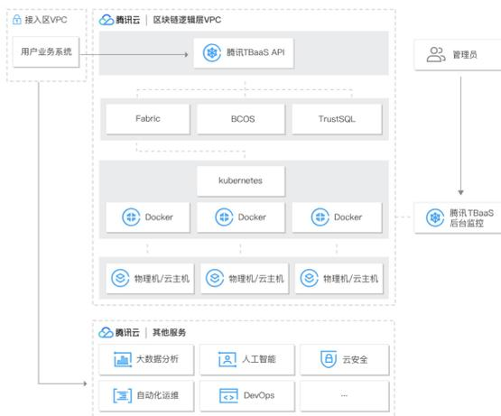
图9: 腾讯云TBaaS的基础设施架构
